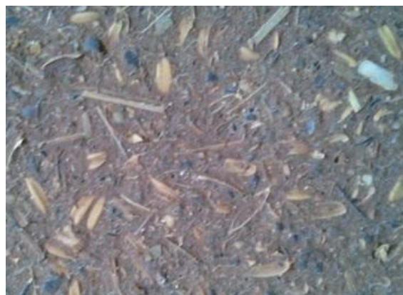
Enduit de corps « C19v1 » fibré à la gerbe de lavande et balle de riz
