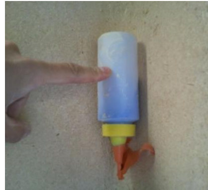
Flacon utilisé pour arrondir un angle rentrant
