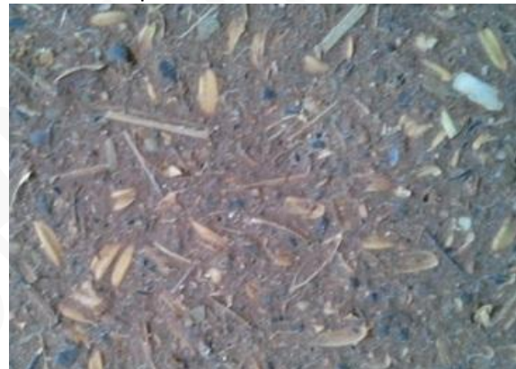
Enduit de corps « C19v1 » fibré à la gerbe de lavande et balle de riz
