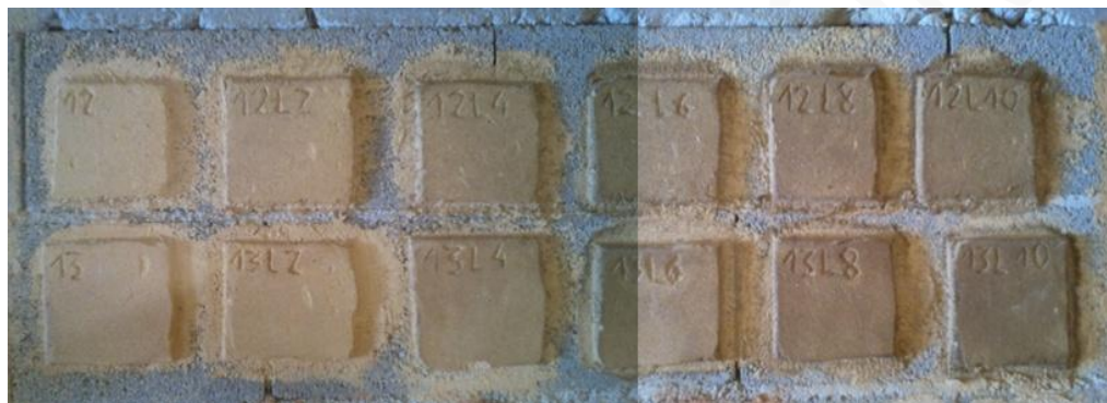
Photo reconstituée. Ajout de proportion croissante de jus de fleurs de lavandes distillées dans un enduit ayant tendance à fariner
