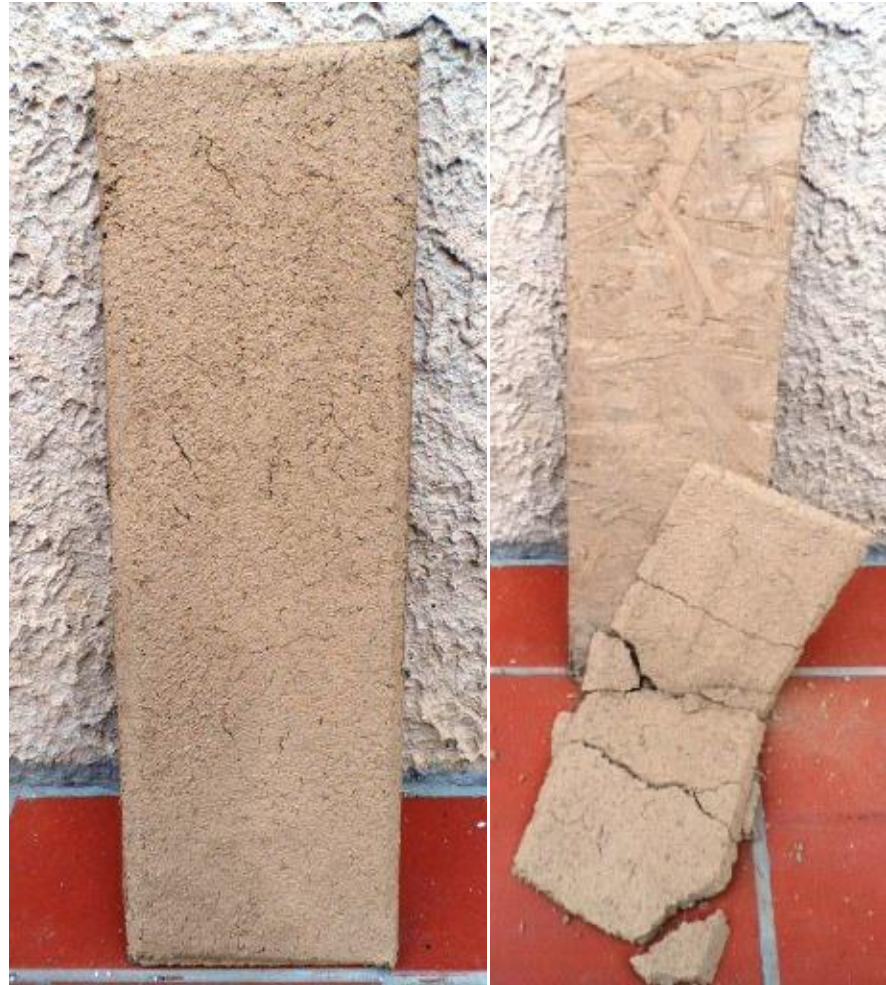
Enduit de corps réalisé sur un vieux panneau OSB (enduit sec à gauche, panneau lâché d'une hauteur de 1 m à droite)
