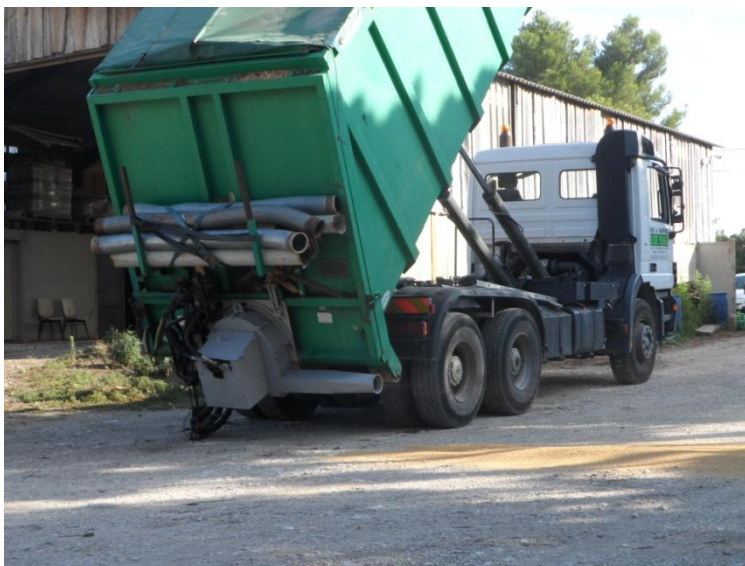
Essai de soufflage (faisabilité) par camion souffleur pour plaquette
