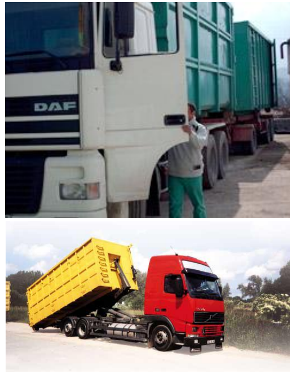
Camion polybenne + remorque / déchargement sur chantier
