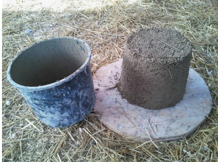
Essais « terre-sable-balle de riz-paille de riz » pour plancher intermédiaire, chantier participatif, 2014
